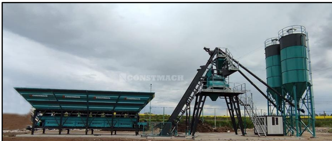
Figure 2-6: Centrale à béton compacte.
