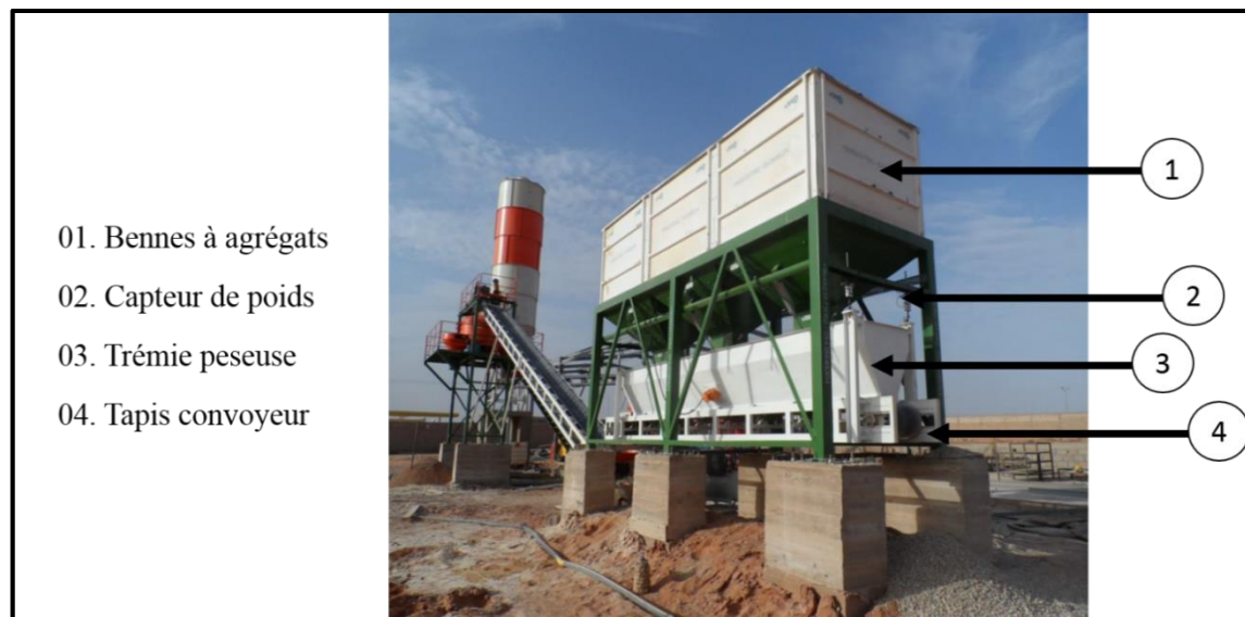
Figure 2-7: Système de pesage à trémies à agrégats.
