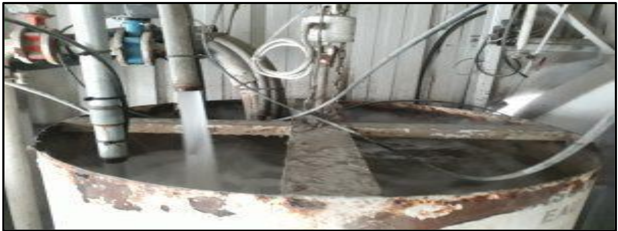
Figure 2-9: Trémie de pesage (Eau ou ciment ou adjuvants).
