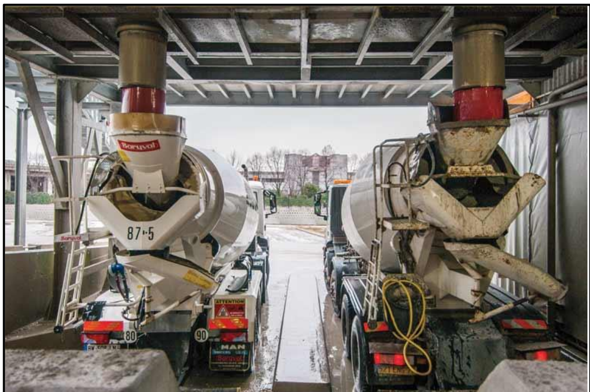
Figure 2-14:Vidange d'un malaxeur par sa trappe vers un camion toupie.
