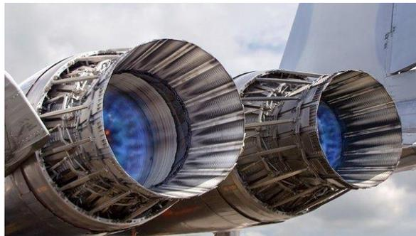
Figure (II, 4) : tuyère à section variable
