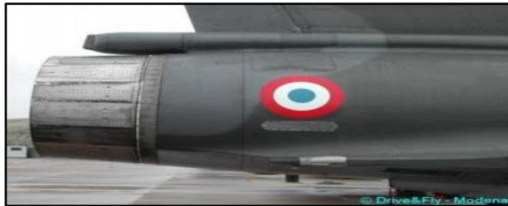
Figure (II, 9) : Tuyère à section variable
