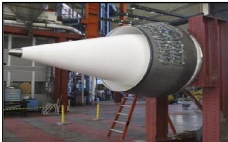
Figure (II, 8): Tuyère a noyau centrale
