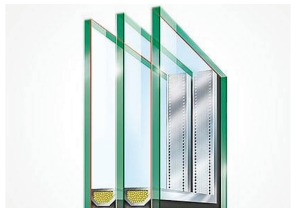
figure 133: Le système du triple vitrage, source evmglass.com
