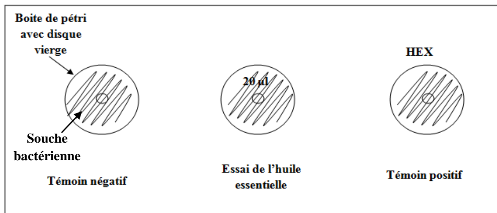
Figure 10. Schéma montrant les étapes de la méthode utilisée dans l'activité antifongique (Originale, 2016).
