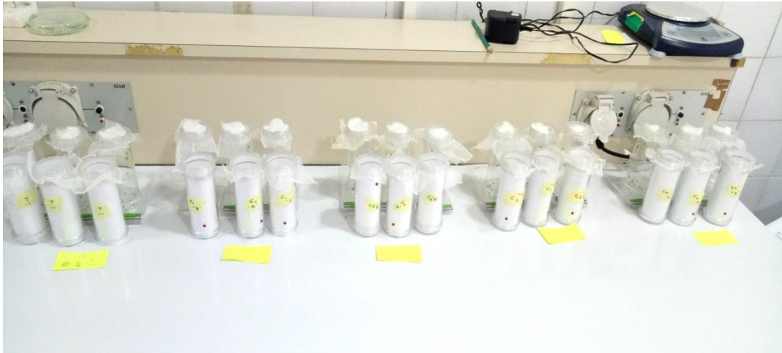
Figure 31 : Dispositif de l'OMS pour tester la sensibilité des moustiques adultes (Originale, 2019).
