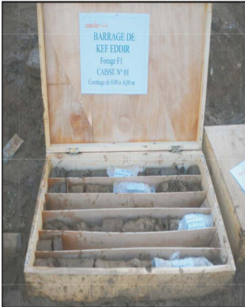
Forage F1 Profondeur: 0.00 - 6.00 m
