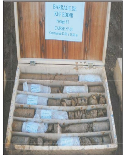
Forage F1 Profondeur: 12.00 - 18.00 m
