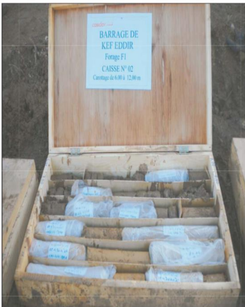
Forage F1 Profondeur : 6.00 - 12.00 m
