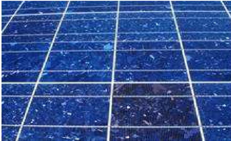
**Fig20** - Les cellules poly-cristallines
