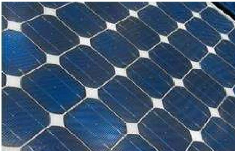
**Fig19** -Les cellules monocristalline
