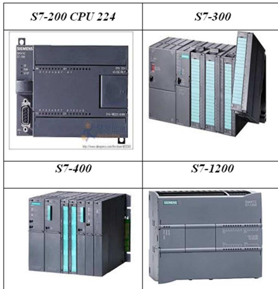
Figure 4-3 : Différents modèles de L'A.P.I SIEMENS S7
