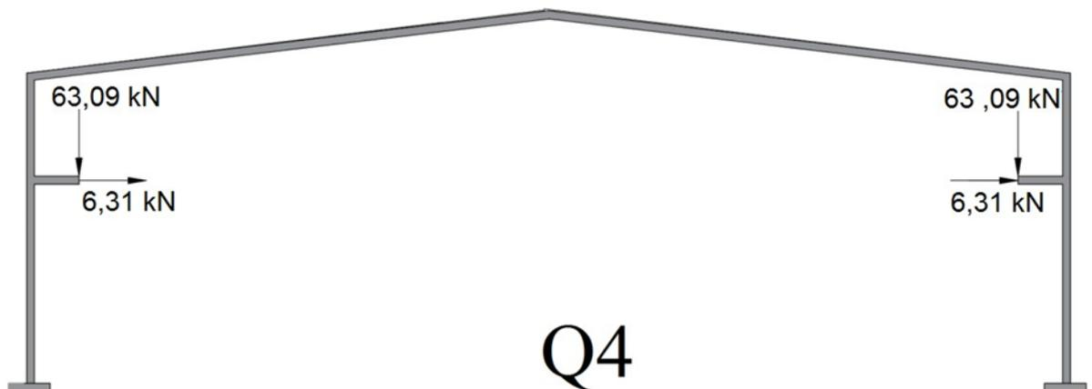
Figure 8.15 : chargement du portique sous Q4.
