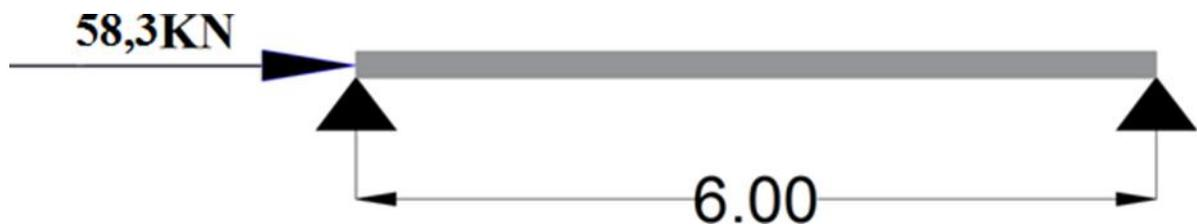
Figure 7.12- schéma statique de sablière .
