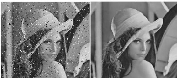
**Figure 1.3 : Image avant (gauche) et après (droite) la suppression du bruit avec le filtre médian [4].**
