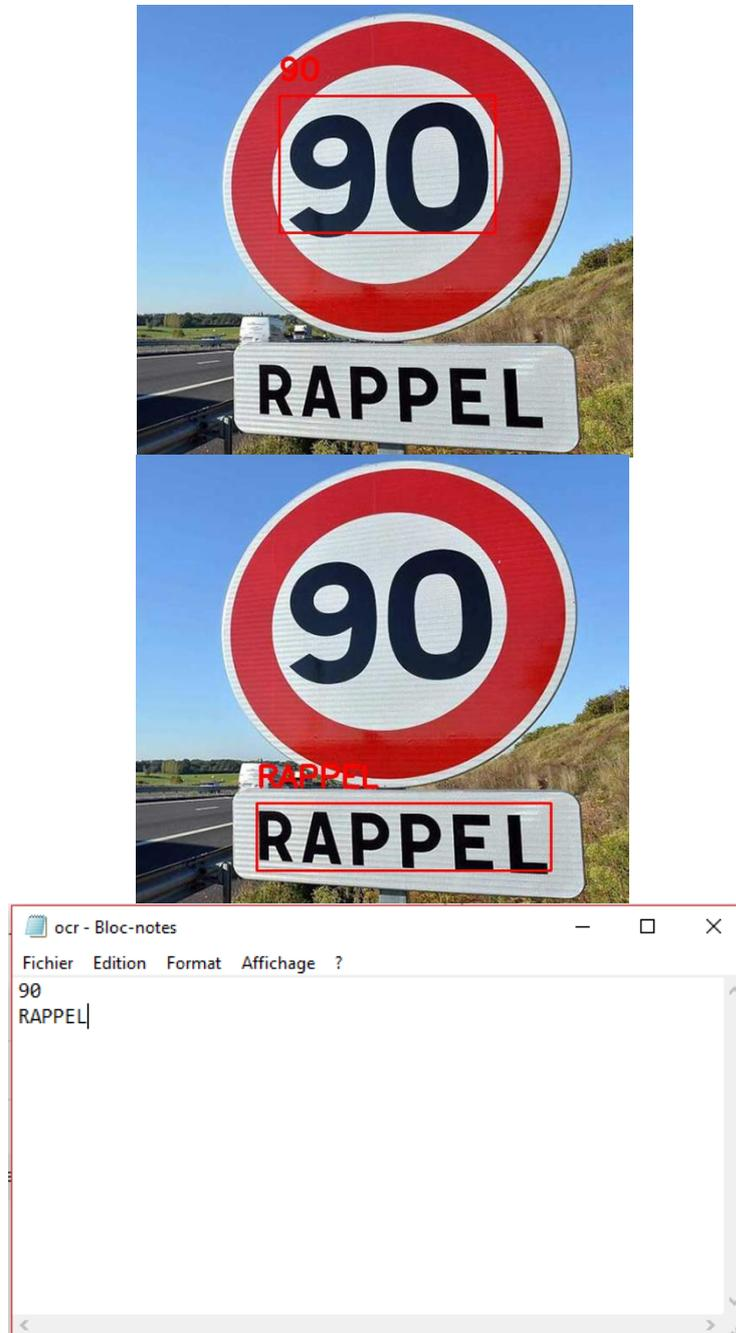
**Figure 3.12 : Une image d'un panneau de signalisation « rappel 90 » détecté et identifié avec la sortie enregistrée dans le fichier .txt.**
