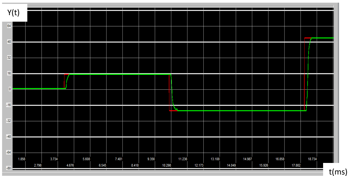
Figure3.28. Réponse du moteur après un changement de consigne 16° à -19° à 50°, avec les paramètres K_p=7,8 ; K_i=2,77 ; K_d=0,312 .
