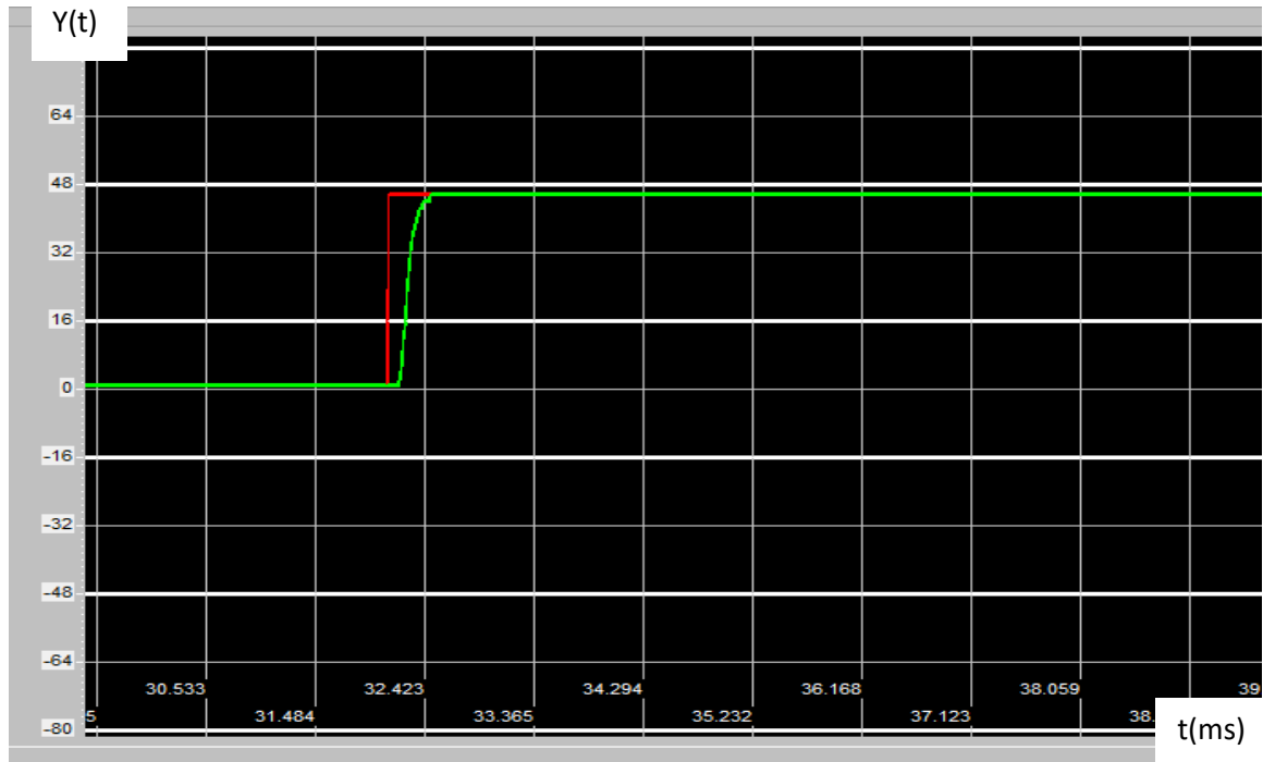
Figure3.26. Réponse du moteur en fonction du temps avec K_p= 7,8 ; K_i=2,77 ; K_d=0,312 .
