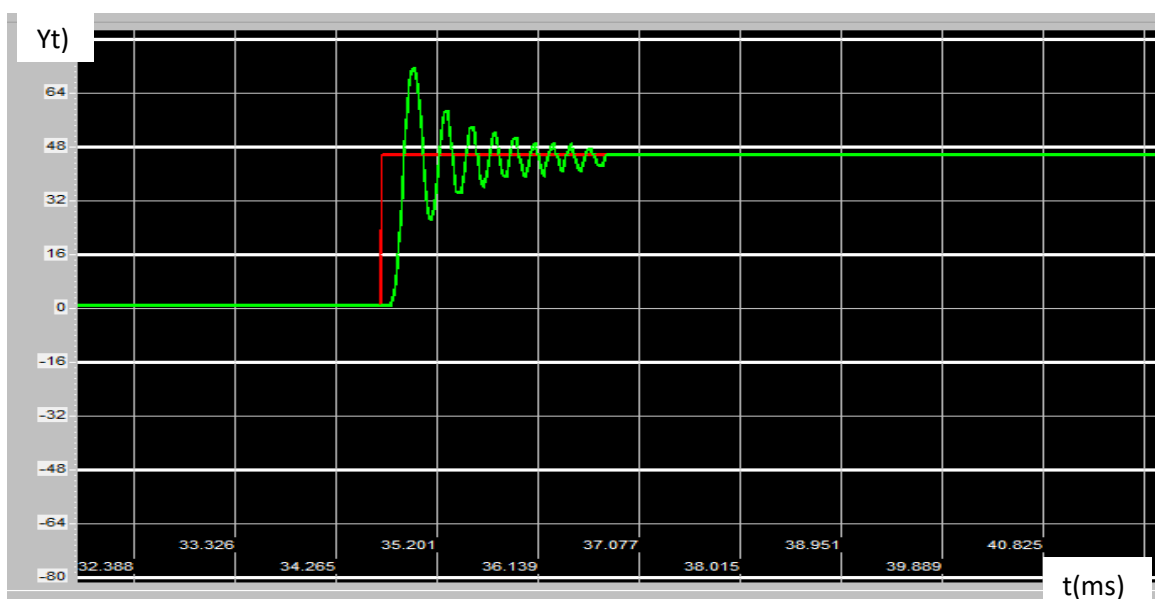
Figure 3.24. réponse du moteur en fonction du temps avec K_p = 7,8 ; K_i = 0 ; K_d = 0 .
