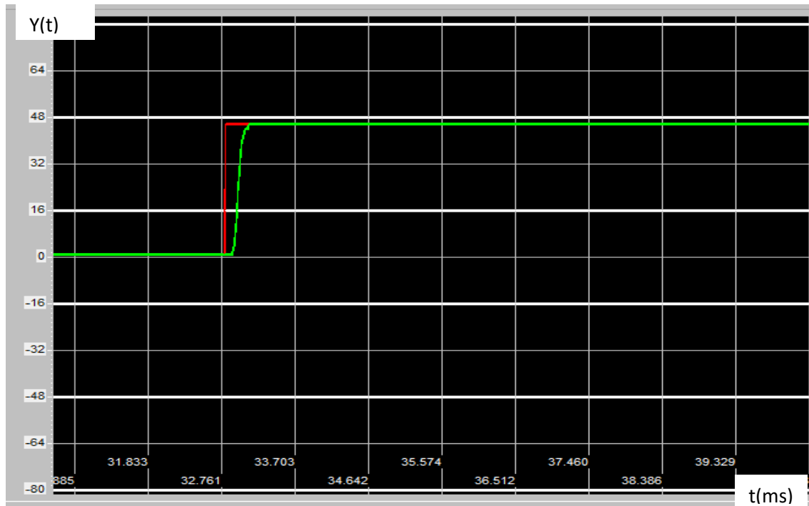
Figure 3.20. Réponse du moteur en fonction du temps avec K_p= 7,5 ; K_i=3,1 ; K_d=0,23 .
