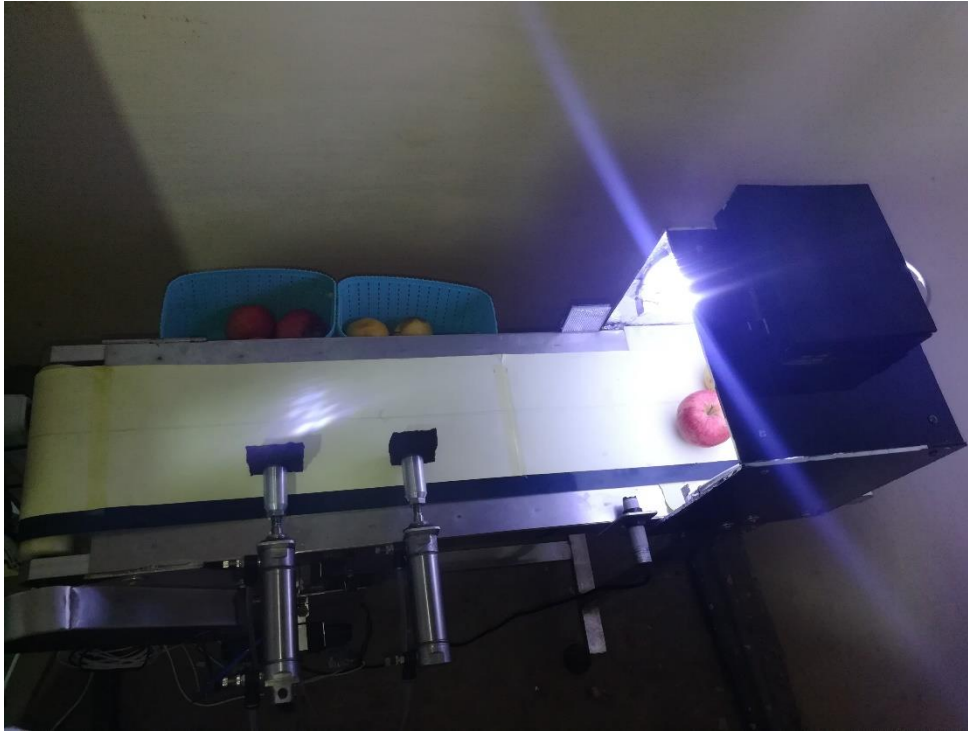
Figure IV.15 : Vue de dessus du convoyeur et de la chambre d'imagerie
