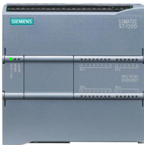
Figure I. 4: L'état des modes fonctionnement de S7-1200
