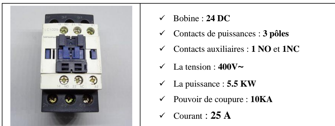
Figure III. 1 : Caractéristiques des contacteurs Schneider LC1D25
