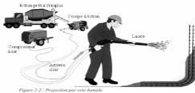
Figure I.22: béton projeté par voie humide.
