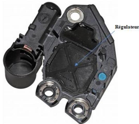
**Figure 1. 8. Régulateur de l'alternateur.**
