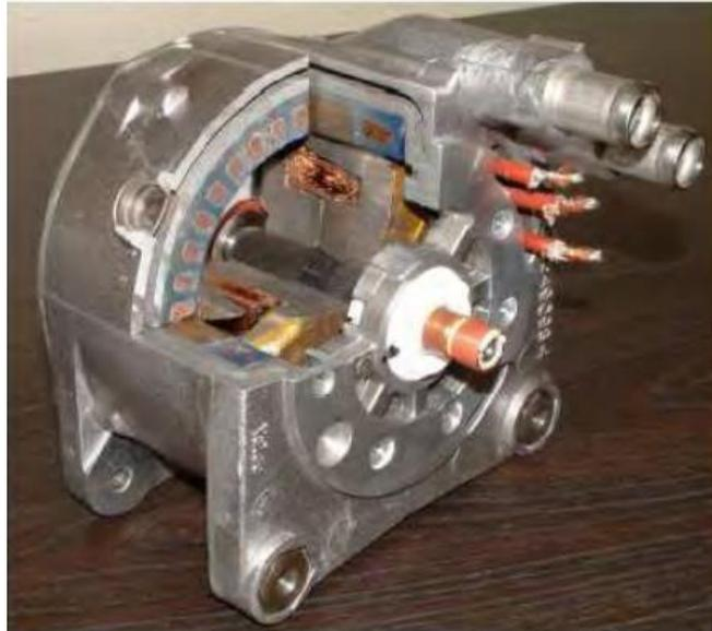
**Figure 1. 9. Alternateur refroidi à l'eau.**
