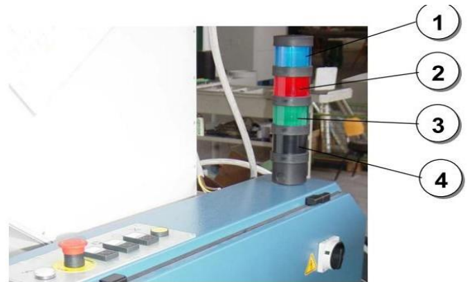
Figure I.8: Colonne lumineuse signalisation état machine.
