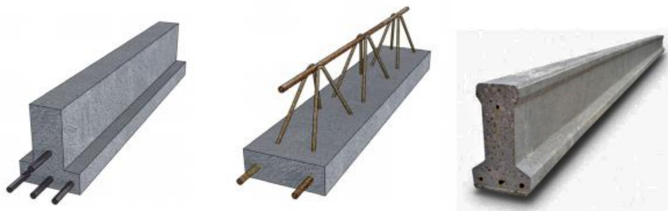
Figure II.5 : Types des Poutrelles.
