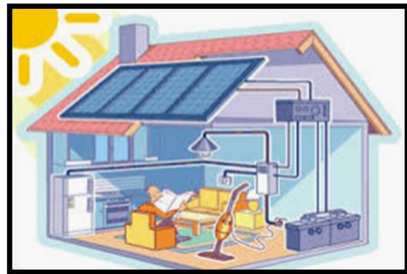
Figure18 : schéma simplifié d'une installation photovoltaïque en configuration de revente totale de la production (Source : guide photovoltaïque particuliers. 2020)
