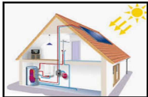
Figure19 : capteur solaires thermique (Source ; guide photovoltaïque particuliers 2011)
