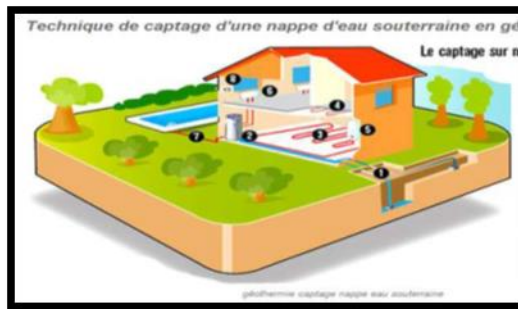
Fig 176: captage sur nappe d'eau souterrain;(Source : futures sciences.2015)
