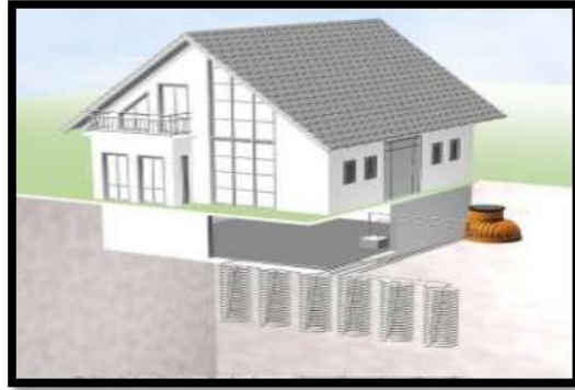
Fig157: captage géothermique vertical;(Source : futures sciences 2015)
