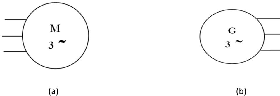
**Figure 1. 1 :** (a) : Symbole général d'un moteur asynchrone triphasé, (b) : Symbole général d'un générateur asynchrone triphasé.
