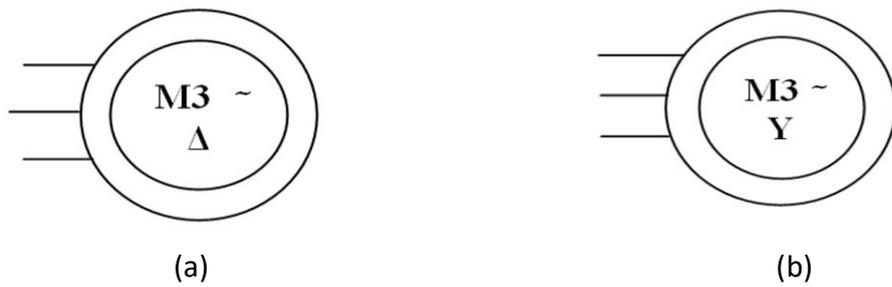
**Figure 1. 3 :** (a) Symbole d'un moteur asynchrone triphasé couplé en triangle, (b) Symbole d'un moteur asynchrone triphasé couplé en étoile
