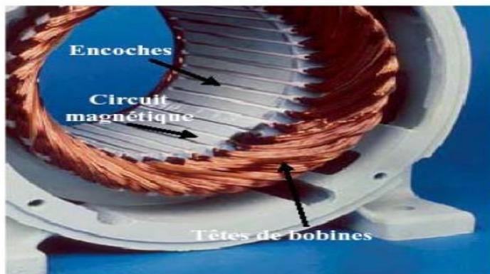
Figure 1. 5 : Photo du stator d'une machine asynchrone
