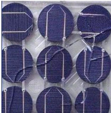
Figure II.3: Effet du point chaud sur les modules photovoltaïques
