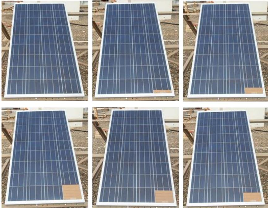
Figure II.14 Niveaux d'ombrage considérés pour cellule PV
