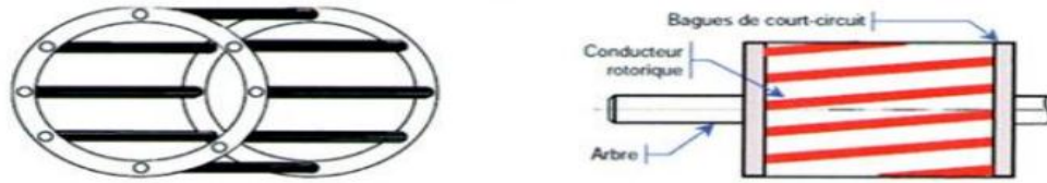
Figure 1. 4. Rotor à cage (tôles magnétiques, conductrices d'encoches (barres) et anneaux (bagues) de court-circuit)
