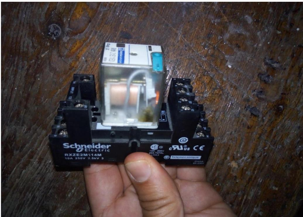
**Figure 3.18.** Module relais de 12V de la gamme Schneider.
