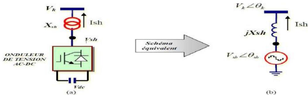
Figure 2.6. STATCOM, (a) structure de base, (b) schéma équivalent.
