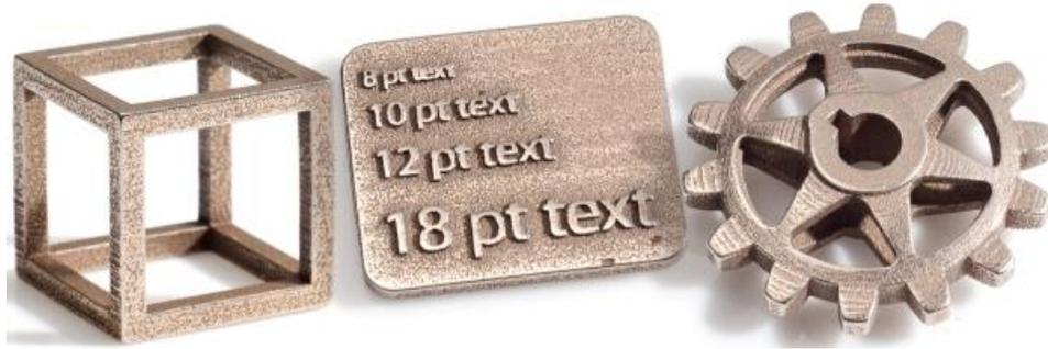
Figure 1.9: Objets métalliques imprimés en 3D
