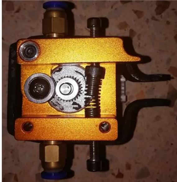
Figure 2.37: Support du moteur de l'extrudeuse assemblé.
