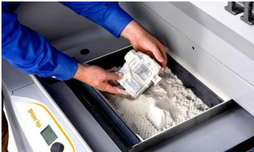
Figure 1.7: Objet 3D imprimé par collage de poudre
