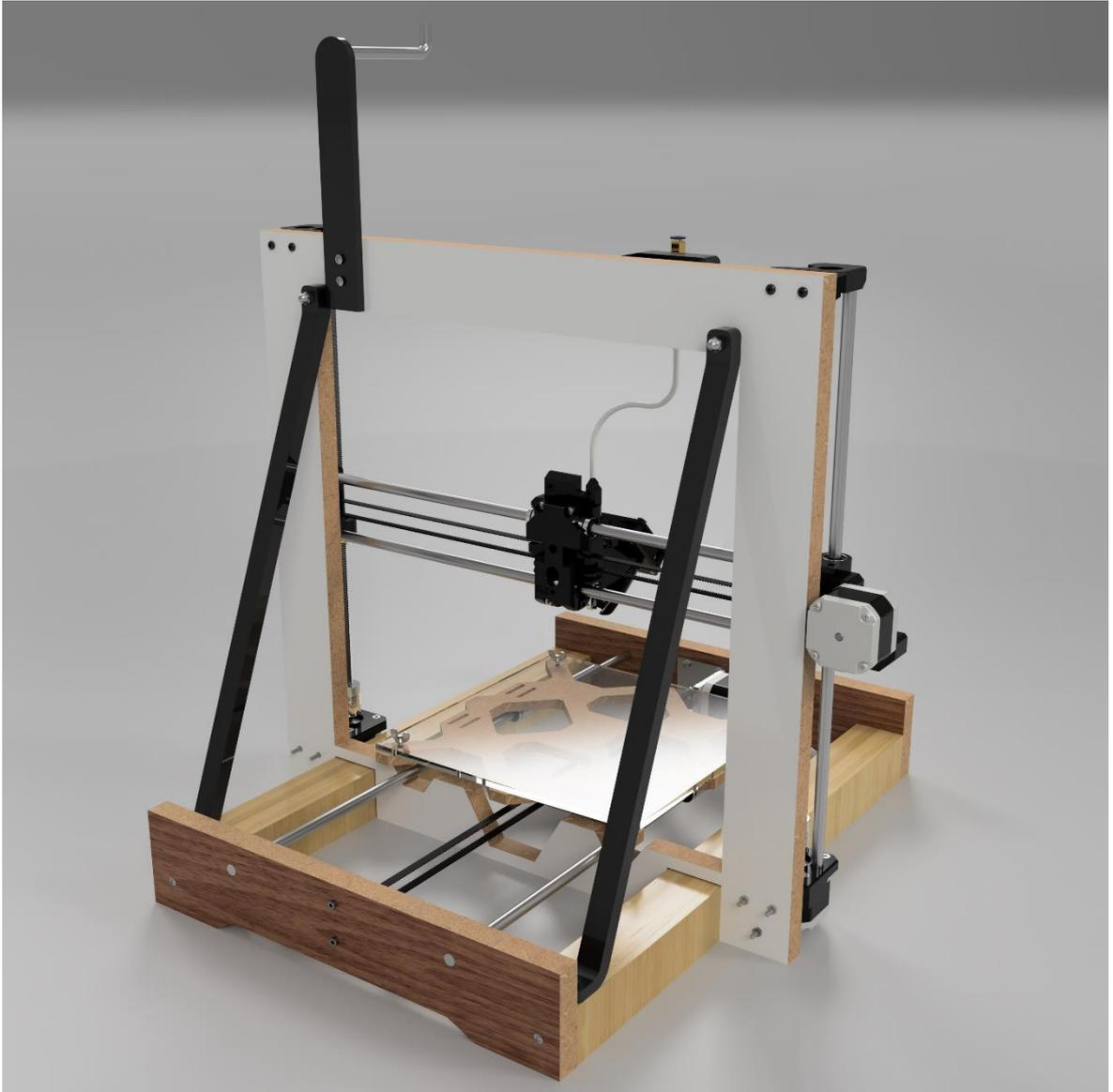
Figure 2.10: Vue arrière du modèle 3D de notre imprimante 3D dans Fusion 360
