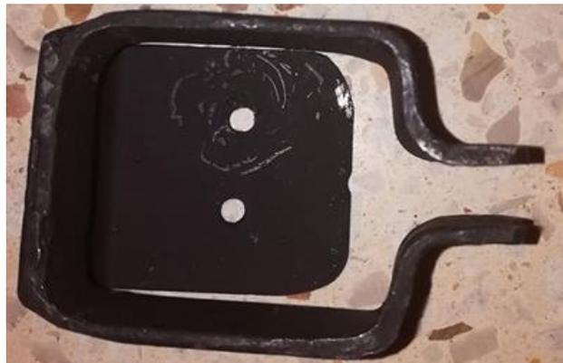
Figure 2.36: Support du moteur de l'extrudeuse.
