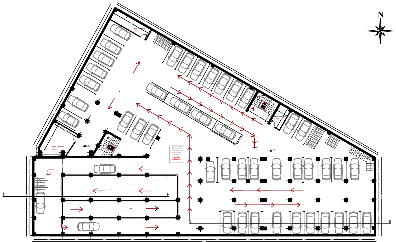
Plan sous sol 2 PARKING -Niveau -5.60 -
