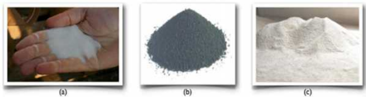
Figure I-63 : Exemples de charges utilisées dans les CMO : (a) micro-billes de verre, (b) noir de carbone, (c) silice [11]
