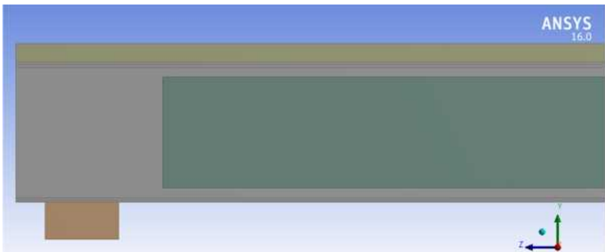
Figure III.41 : Renforcement poutre par Lamelle Sika Carbodur et tissu Wrap
