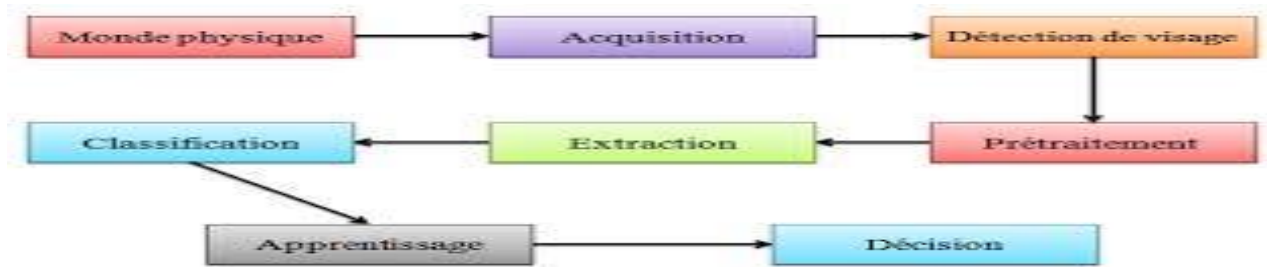
Figure I.2 : Schéma de fonctionnement de la reconnaissance de visage.
