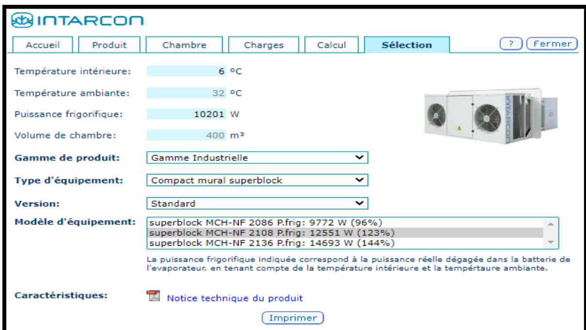
Figure 4.2 : Exemple choisi sur un type d'un évaporateur pour la chambre 01[9]
