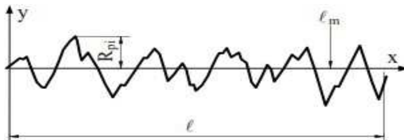
Figure 2.10. Représentation de paramètre d'état de surface R_p .
