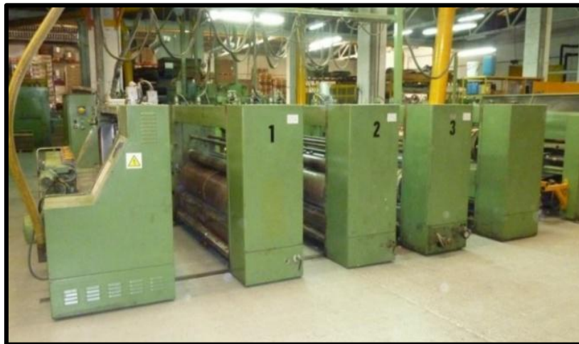
Figure II.7 : groupes découpeurs rotatifs (Curoni)
