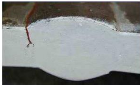
h. ramification à la pointe d'une fissure à la ligne de fusion de soudure.
