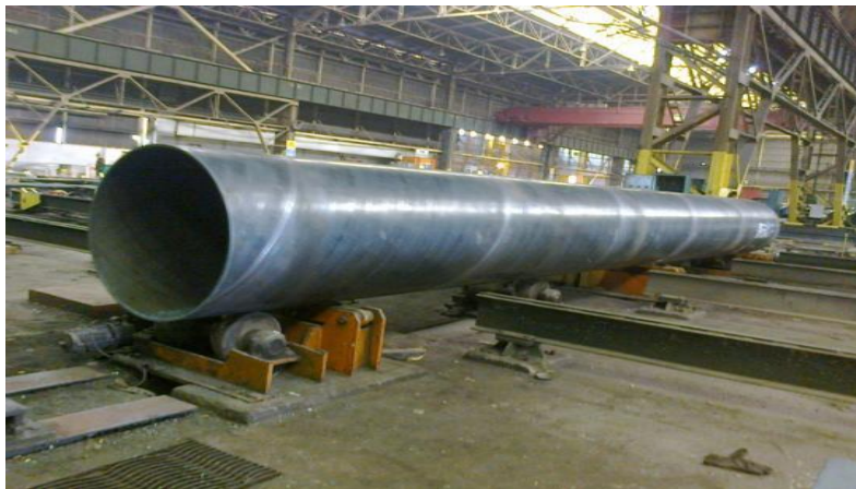
FIGURE I.2 : LES TUBES SOUDES SOUS LA FORME EN SPIRALE.
