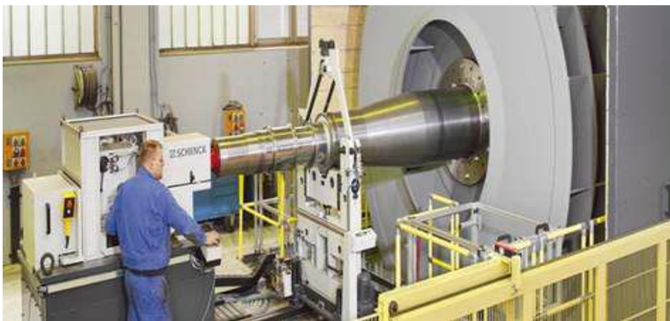
Figure II-10 : Balance d'équilibrage statique utilisée pour des Rotors Turbomachine [14].
