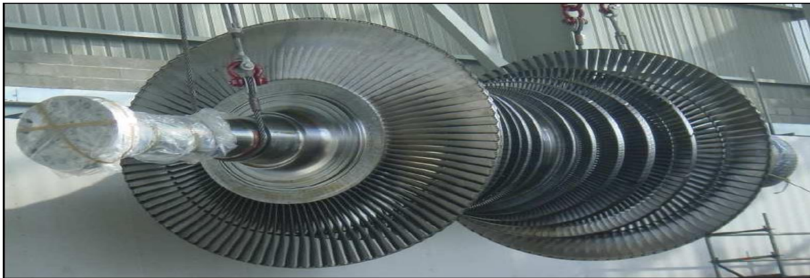
Figure I-12 : Rotor de la turbine basse pression.
