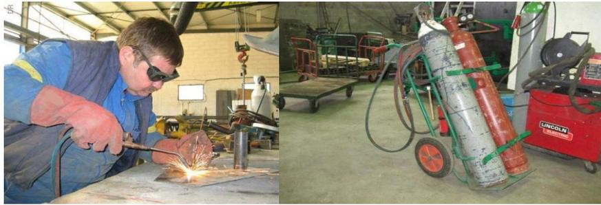
Figure I .1. Soudage au chalumeau
