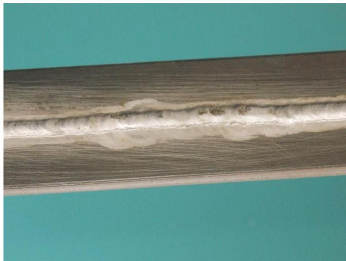
**Figure II .13 :** Apparition d'une fissure lors du soudage TIG d'un alliage
