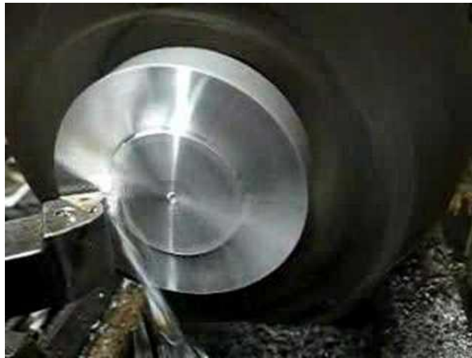
Figure III.2 : Opération de dressage (tournage)
