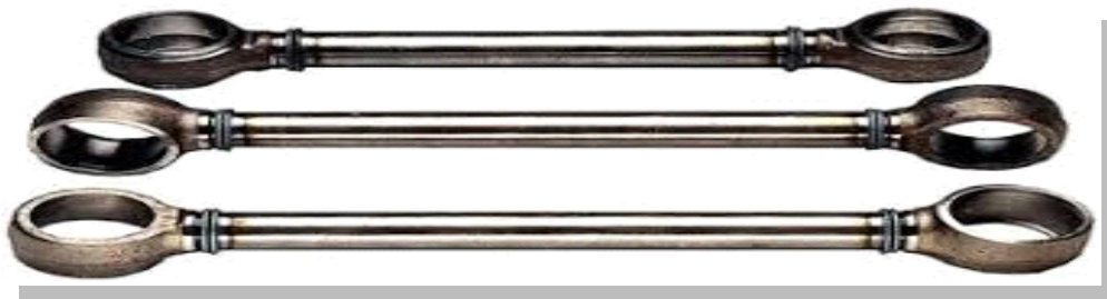
Figure II-15 : Arbres de transmission soudés par friction.[13].
