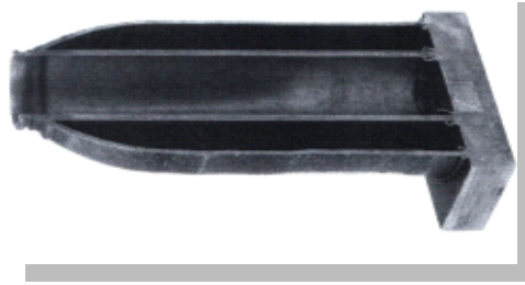
Figure II-8 :Partie d'un cric hydraulique : Soudé à une pièce compressée [1].
