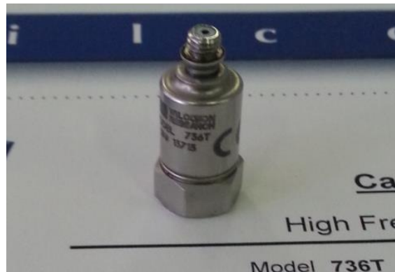
Figure IV- 3 Accéléromètre (Wilcoxon 736T).[Doc CRD/MA].
