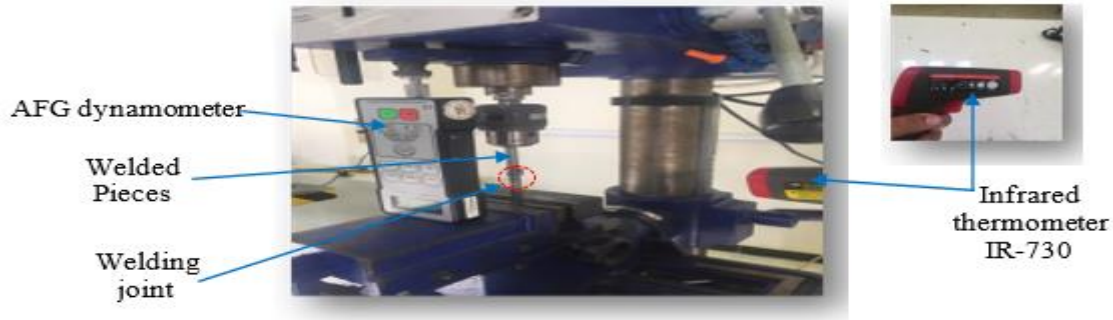
Figure II-16 : Schéma de l'installation expérimentale de soudage et ces instruments.
