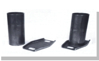
Figure II-7 :Partie d'un amortisseur :tube le tube à double paroi est soudé en une fois [1].
