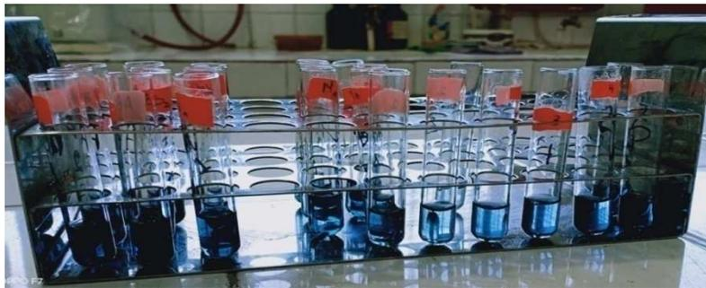
**Figure 14** : Coloration des tubes après réaction des protéines.
