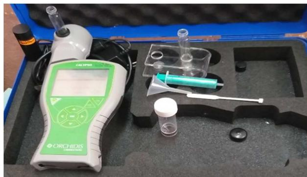
**Figure 21 : Photopode de multi-para mètre CALYPSO (SN-ODEOA-2348).**
