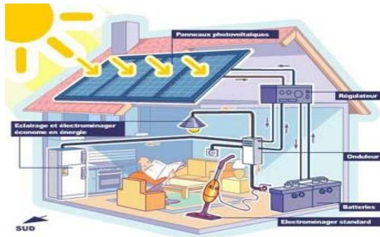
Figure 5.1 : système autonome.
