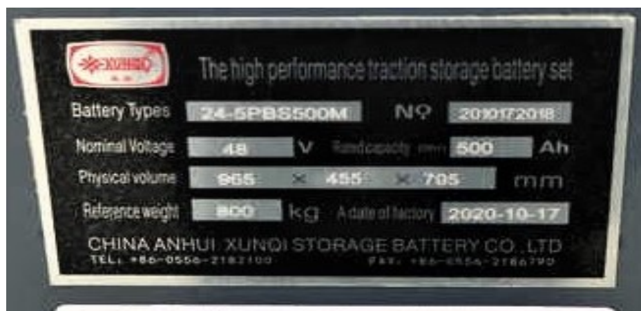
Figure 2-3 : Les caractéristiques de la batterie
