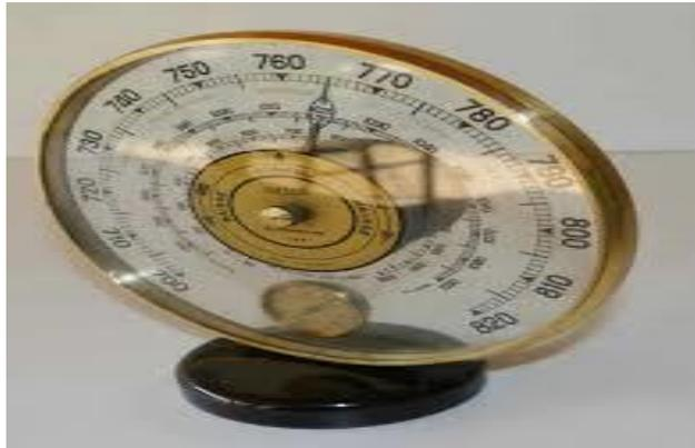
**Figure I.8:** Baromètre anéroïde.
