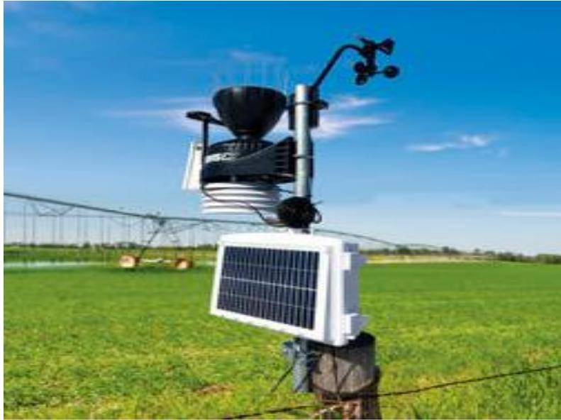
**Figure I.2:** Station météo automatique [2].
