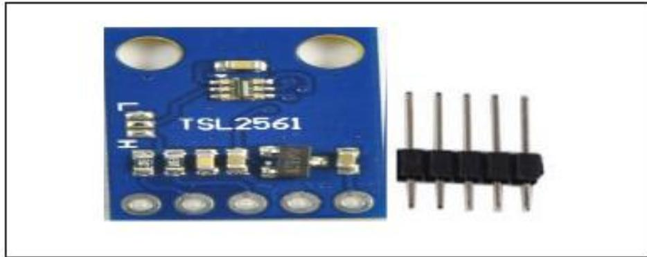
**Figure II.12:** Le capteur de luminosité TSL2561.
