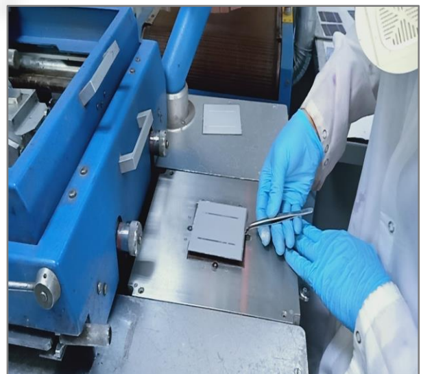
Figure 2. 29: sérigraphie de la pâte d'aluminium en face arrière/ CRTSE
