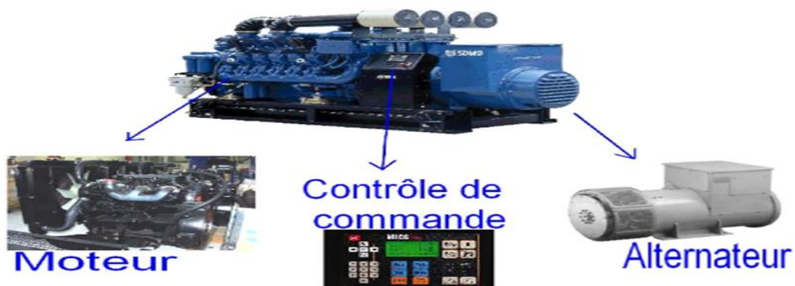
Figure 2. 11. Les composantes essentielles d'un groupe diesel [32].
