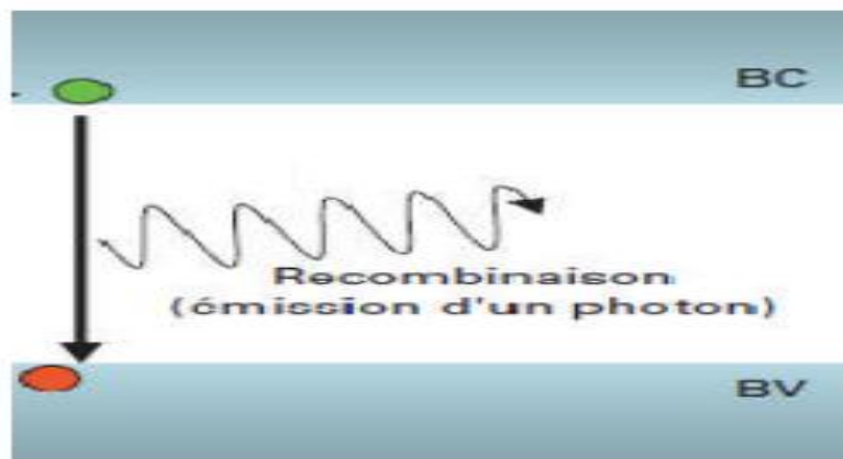
Figure I.10. Schéma représentatif du phénomène de la recombinaison Radiative [14]
