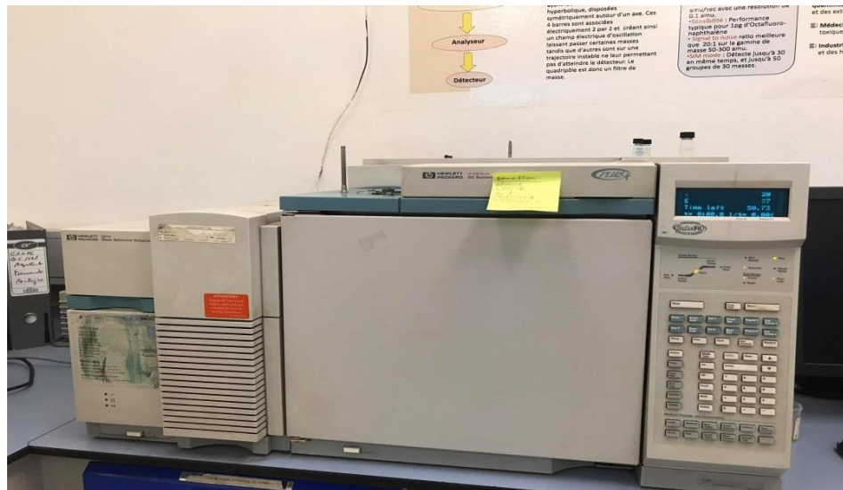
Figure 2.1: chromatographie gazeuse associée à la spectroscopie de masse.
