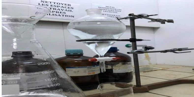
Figure 2.9: La solution aqueuse à extraire dans l'ampoule à décanter.
