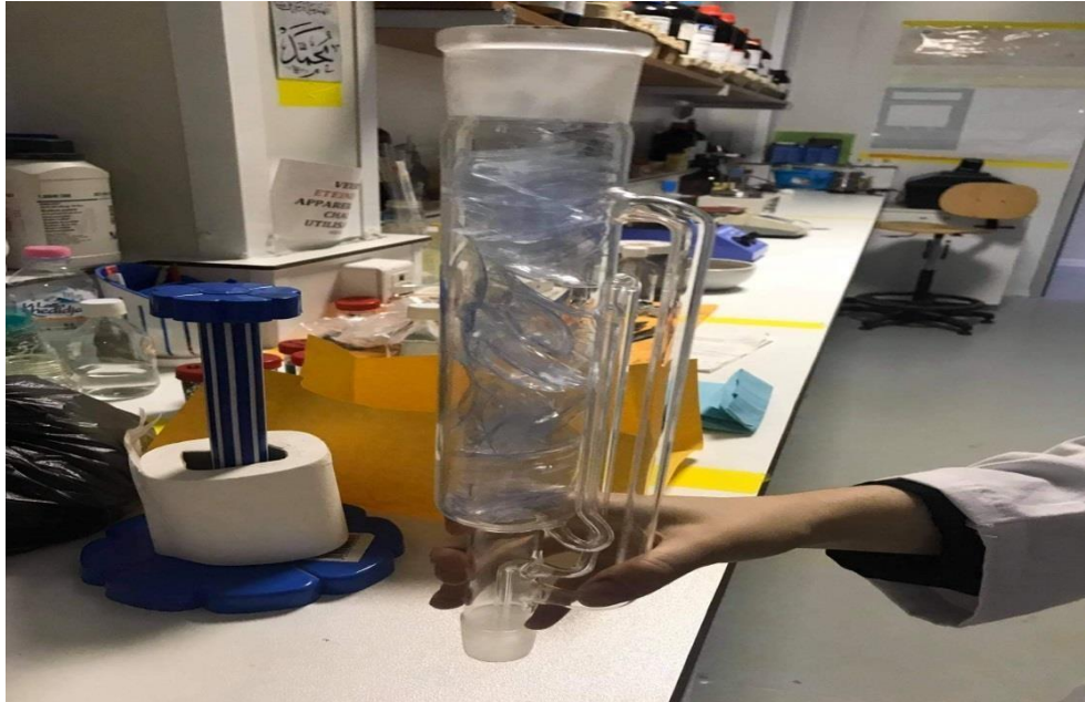
Figure 2.12 : Morceaux de plastique dans letube soxhlet.
