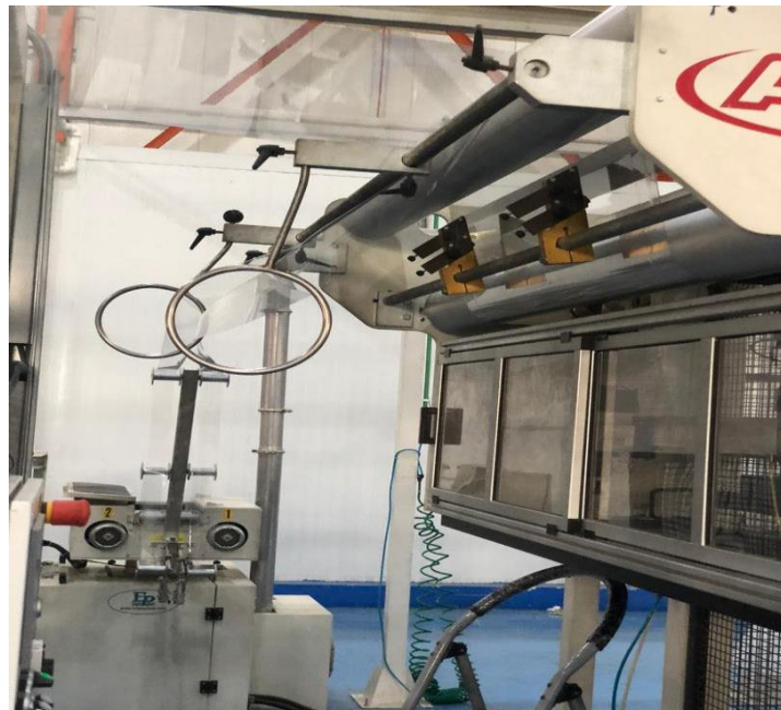
Figure V.24 : Photographie montrant l’ajustement de la laize
