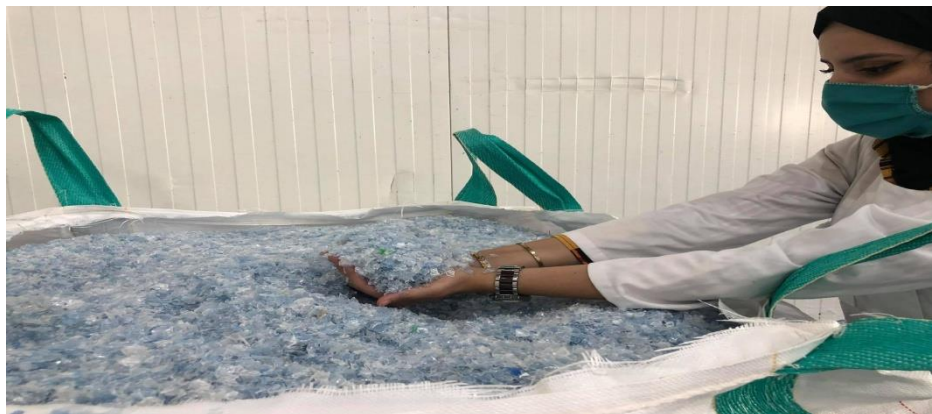
Figure V .17 : Photographie montrant Big bag de pet recyclé
