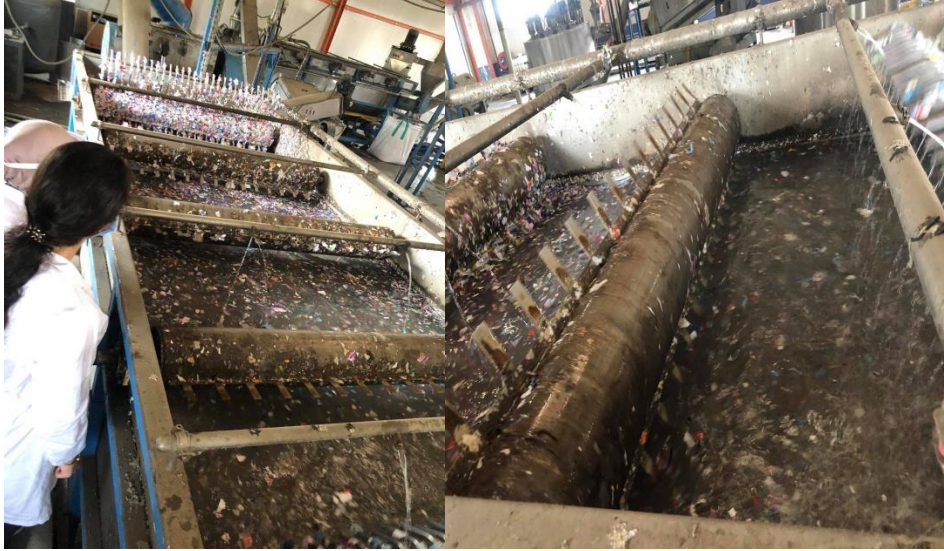
Figure V .7 : Photographies montrant (A) : Bassin 1 de séparation par densité ; (B) : Bassin 2 flottation
