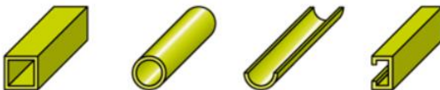
Figure I .7: Types de profile obtenu par extrusion
