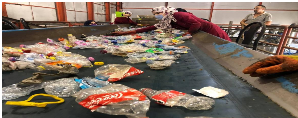
Figure V .2 : Photographie montrant le tapis manuel utilisé
