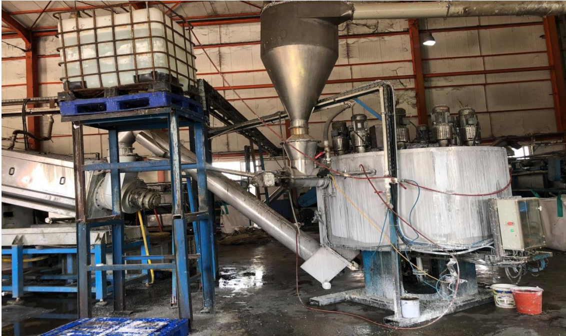
Figure V .10 : Photographie montrant Centrifugeuse
