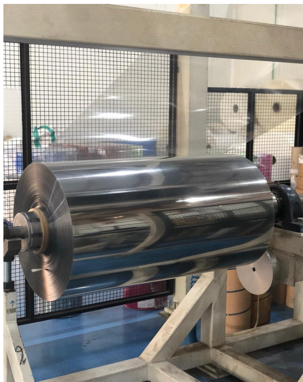
Figure VI 3 : Photographie montrant la Bobine de film alimentaire issu du 2ème essai
