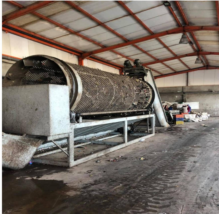
Figure V .3 : Photographie montrant le Trommel utilisé
