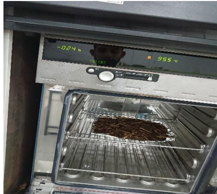
Figure 2. Mettre l'échantillon dans l'étuve
