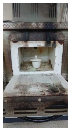
Figure 22. Placement de l'échantillon pour la calcination
