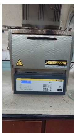
Figure 21. Le four de calcination
