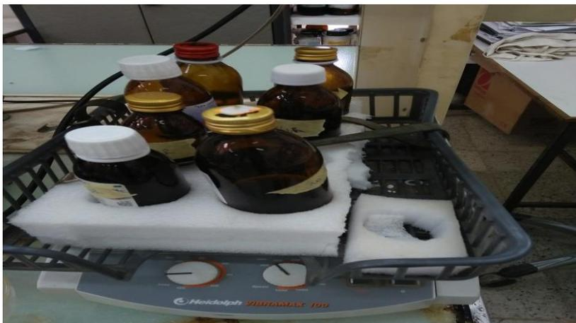
**Figure II.8.** Les essais d'adsorption en utilisant le secoueur.
