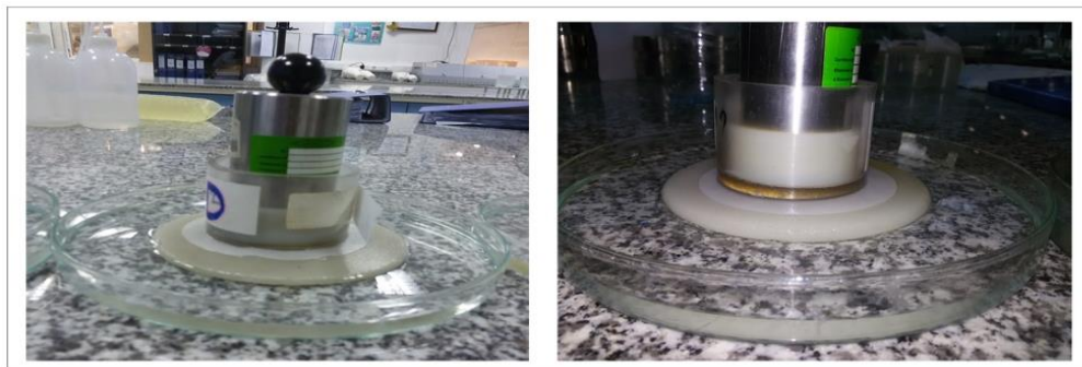
Figure II- 6: Test d'absorption sous charge AUL d'un matériau superabsorbant.
