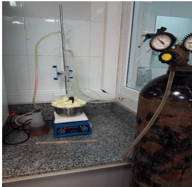
Figure II- 1 : Montage de polymérisation adopté
