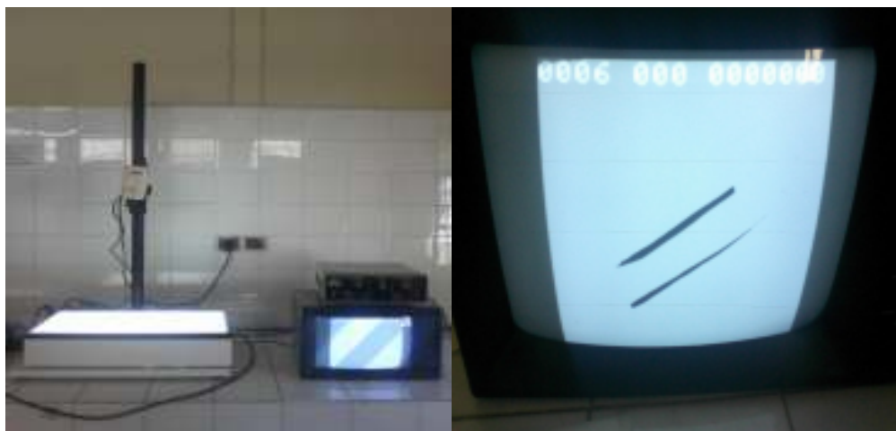
Photos. 04 : mesure de la surface foliaire à l'aide d'un planimètre.
