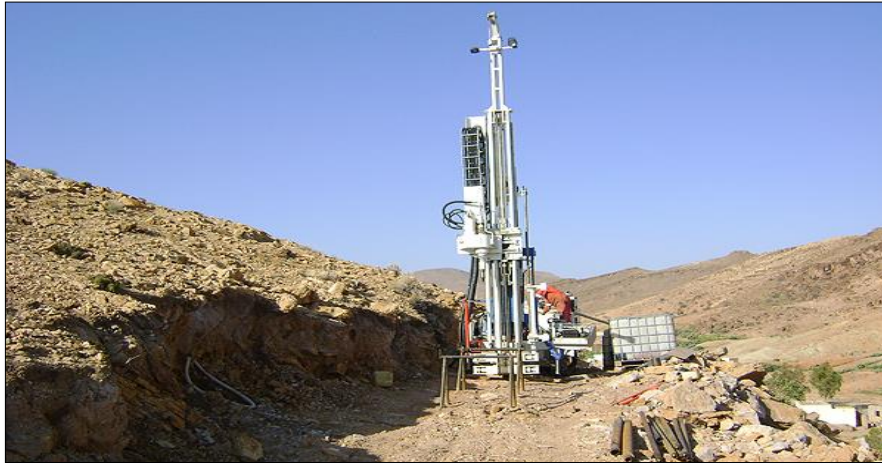
Figure III.5. Prélèvement des échantillons d'un sondages carotté
