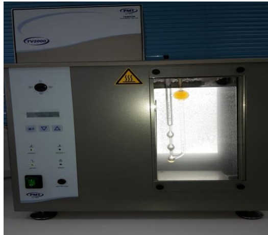
Figure 3.3 : Dispositif de détermination de la viscosité cinématique.
