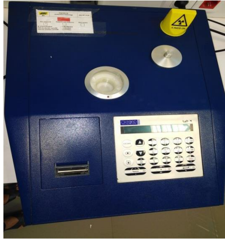
Figure 3.8 : Appareil de détermination de la teneur en soufre aux rayons X.
