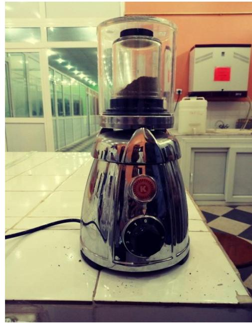
**Figure 18 :** Un broyeur électrique utilisé pour broyer les échantillons.
